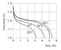
SELF DISCHARGE RATE AT VAROUS TEMPERATURES
